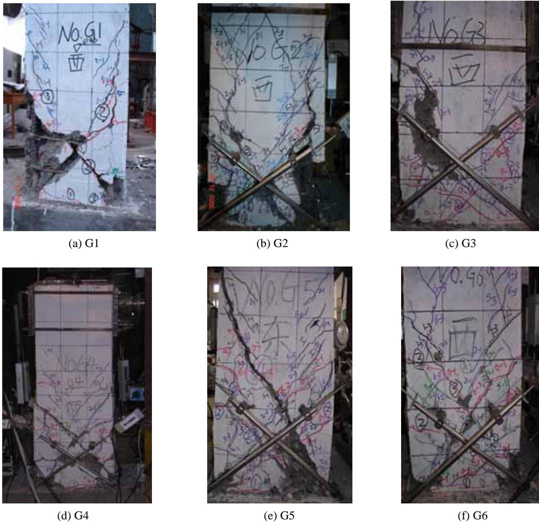
图 3 高强混凝土柱的破坏形态
